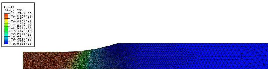
(b) Endommagement fils longitudinaux
