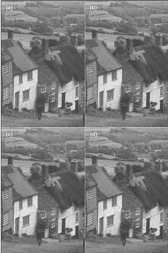
FIG. 3.9 – Comparaison visuelle de différentes méthodes de compression pour un débit de 0,25 bpp. (a) Extrait de l'image GOLD originale; (b) EB-WIC (PSNR=31,70 dB); (c) SPIHT (PSNR=31,33 dB); (d) JPEG-2000 (PSNR=31,47 dB). Les images ont subi un renforcement des contours sous le logiciel PHOTOSHOP.
