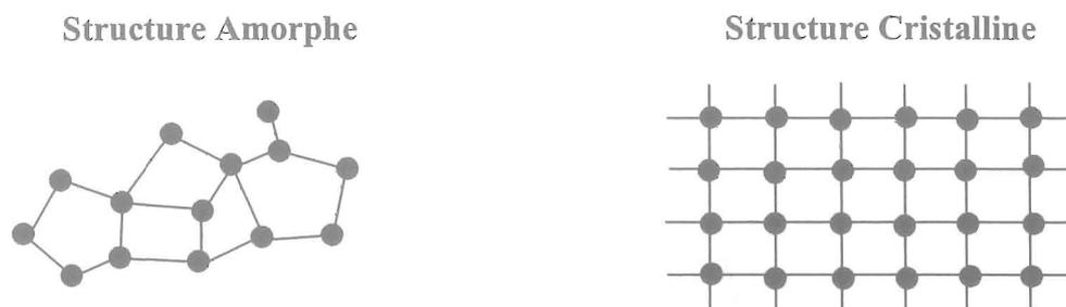
Figure I.4: Représentation de structures de matériaux
