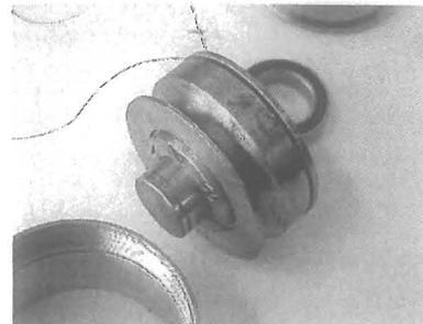
Figure III.18: Partie active de l'actionneur.
