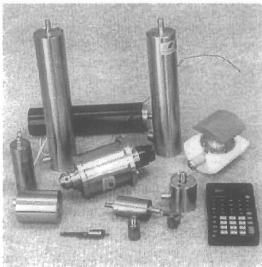
Figure II.14: Exemples d'actionneurs linéaires magnétostrictifs [ETR01].
