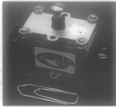
Figure II.3: Actionneur MSM linéaire d'Adaptamat ©, course # 0,6mm, Force bloquée # 3N, Fmax 300Hz, M= 60g.
