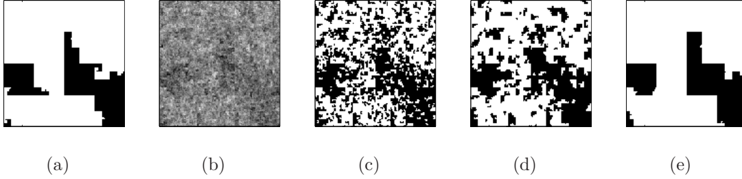
FIG. 5.6 – Segmentation de y_{1:N} lorsque (X, Y) est une chaîne semi-markovienne cachée à mémoire longue : (a) Réalisation de X , (b) Réalisation de Y , (c) Modèle CSMC en non supervisé : 31.15% d'erreur, (d) Modèle CTPM-ML en non supervisé : 21.53% d'erreur, (e) Modèle CSMC-ML en non supervisé : 3.16% d'erreur.
