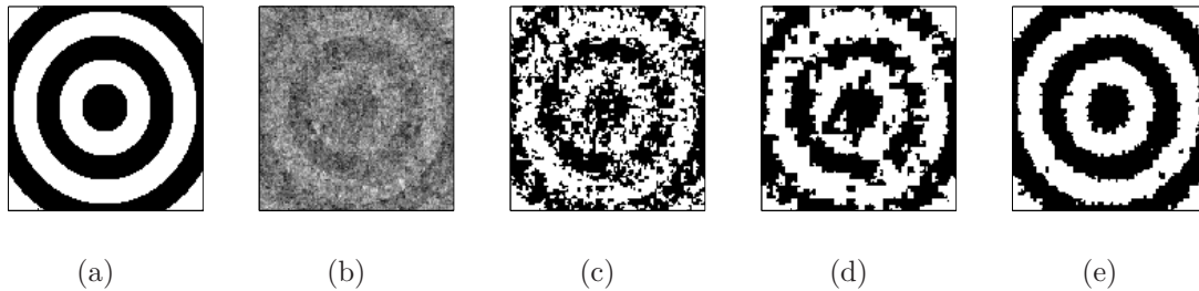
FIG. 5.7 – Segmentation d’une image réelle bruitée avec de la dépendance longue : (a) Réalisation de X , (b) Réalisation de Y , (c) Modèle CSMC en non supervisé : 24.70% d’erreur, (d) Modèle CTPM-ML en non supervisé : 18.27% d’erreur, (e) Modèle CSMC-ML en non supervisé : 6.31% d’erreur.
