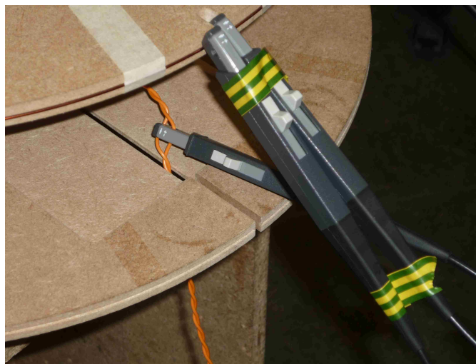
Figure VI.10. Photographie de la mesure différentielle avec des sondes de courants en situation de fort champ magnétique
