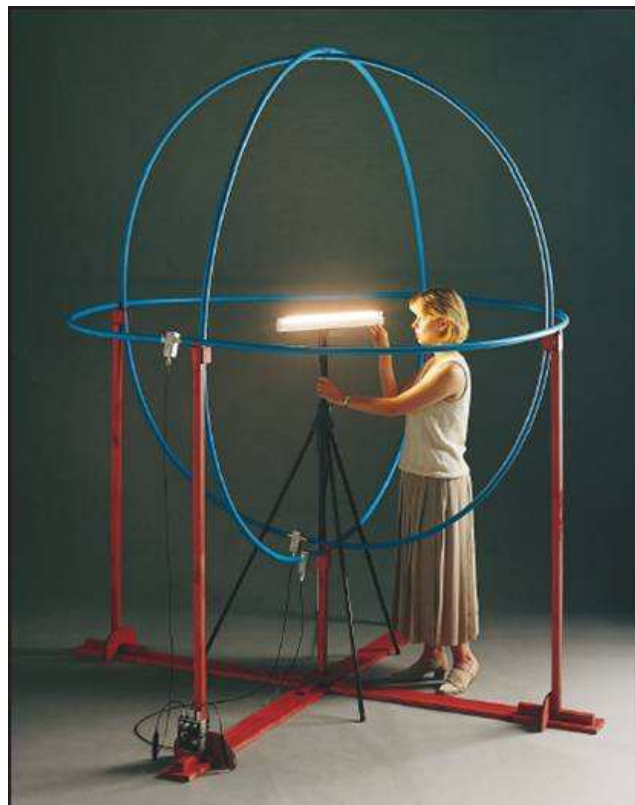
Figure VI.6. Caractérisation de luminaires avec le système « Large Loop Antennas »
