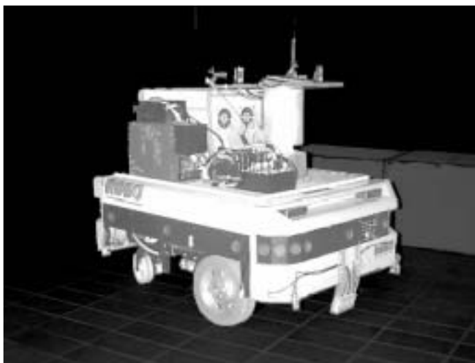
Figure 4-1: Robuter : robot mobile de la société Robosoft .
