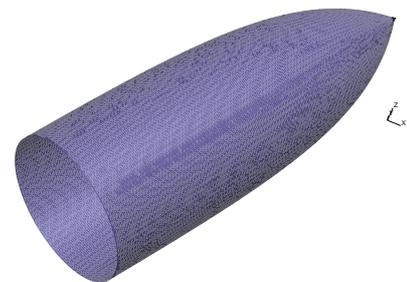
figure IV.2 – Seuil d'élasticité du modèle de Rousselier
