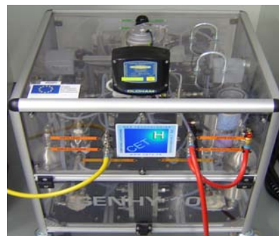
Système d'électrolyseur étudié (CETH GENHY 500W)
