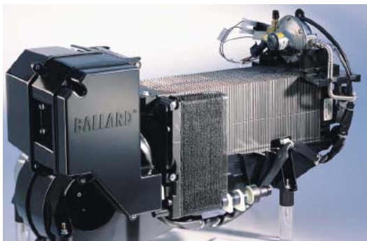
Système de pile à combustible étudié (BALLARD NEXA 1200W)
