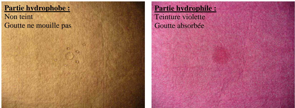
Figure IV.11 - Photos des structures après teinture et test de mouillage à la goutte d'eau
