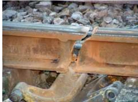
(b) Rupture simple sur soudure
