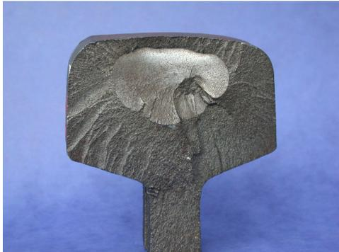
(a) Rupture simple sur rail
