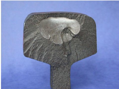
(a) Rupture simple sur rail
