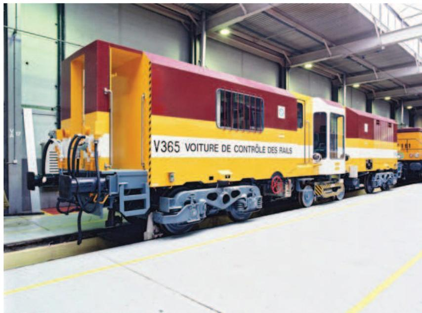
FIG. 4.7 – Voiture de contrôle ultrasonore V365.
