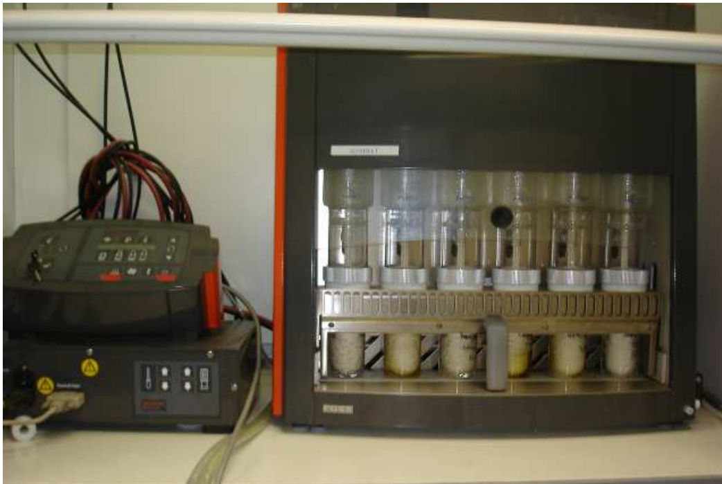
Figure II.2 : SOXTEC au cours de l'étape « boiling ».
