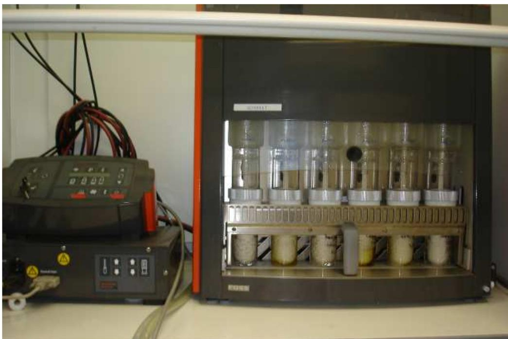
Figure II.2 : SOXTEC au cours de l'étape « boiling ».
