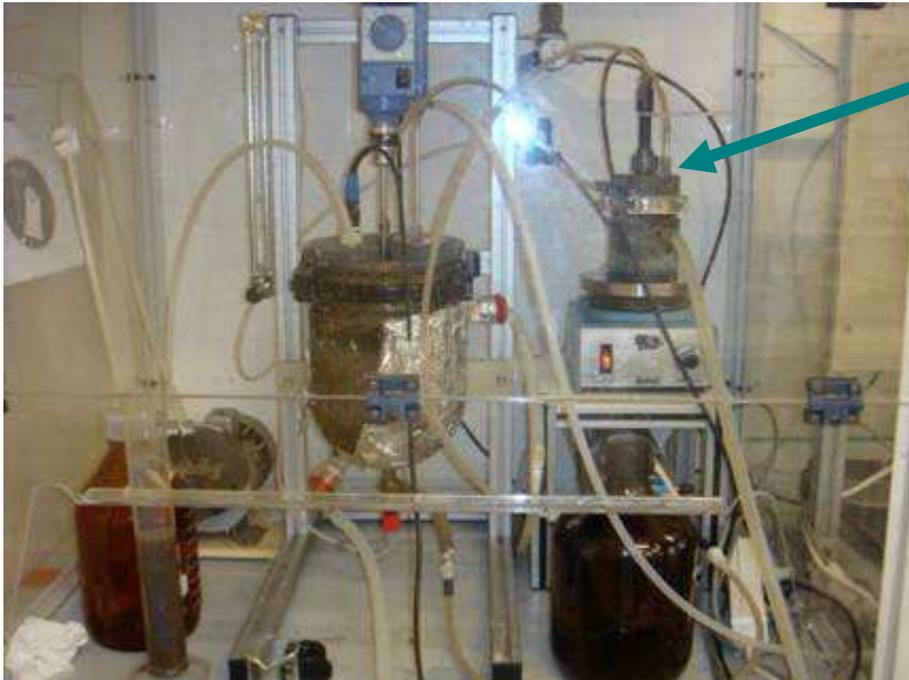
Cellule de mesure de l'oxygène dissous
