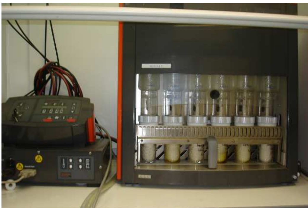
Figure II.2 : SOXTEC au cours de l'étape « boiling ».
