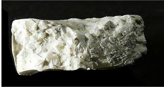
**Figure 118 :** Vue d'un aérogel composite à base de polyuréthane et de granules d'isogel
