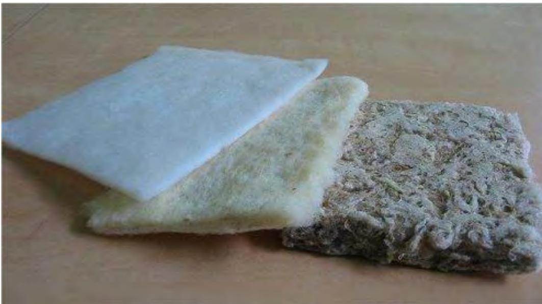
**Figure 57 :** De gauche à droite, blanket de référence (à base de Quartzel®), blankets à base de laine de mouton et de tissus recyclés
