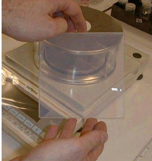
**Figure 19 :** Echantillon typiquement obtenu par séchage au CO<sub>2</sub> supercritique direct (0.15 g/cm<sup>3</sup>, 0.018 W/m.K, %TR ~ 90%)
