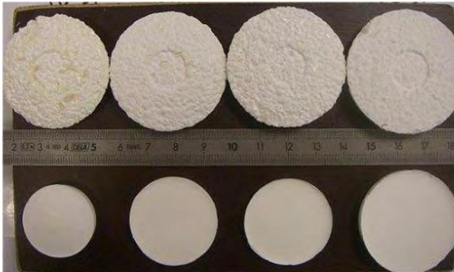
**Figure 119 :** Aérogels de polyuréthane (en bas) et leurs composites à base de granules d'isogel (en haut)
