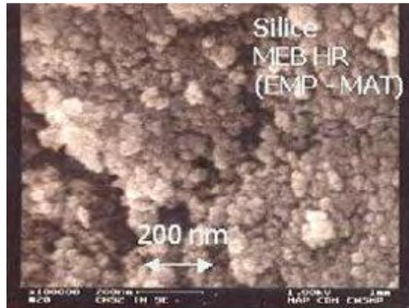
**Figure 9** : Cliché de microscopie électronique à balayage haute résolution (MEB-HR) des aérogels de silice élaborés durant ma thèse (réalisé au Centre des Matériaux de l'EMP à Evry par François GRILLON)
