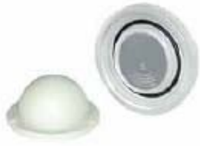
Figure II-9. Porte échantillon étanche utilisé pour les analyses par diffraction X
