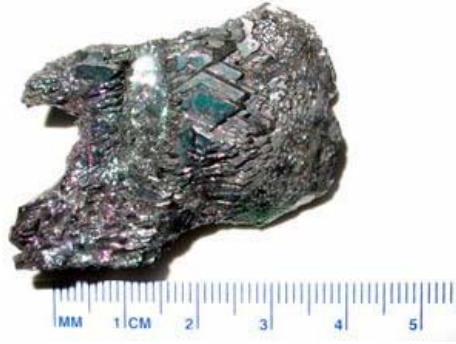
Figure I-10. Un échantillon des cristaux de SiC produit par le procédé Acheson.
