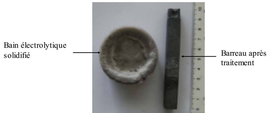
Figure II-6. Cliché photographique d'un bain électrolytique solidifié et du barreau réfractaire après traitement
