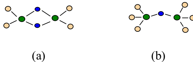
Figure II-32. Les deux espèces oxyfluorées : (a) : \text{Al}_2\text{O}_2\text{F}_4^{2-} (à plus forte teneur en \text{Al}_2\text{O}_3 ) et (b) : \text{Al}_2\text{OF}_6^{2-} (à faible teneur en \text{Al}_2\text{O}_3 )
