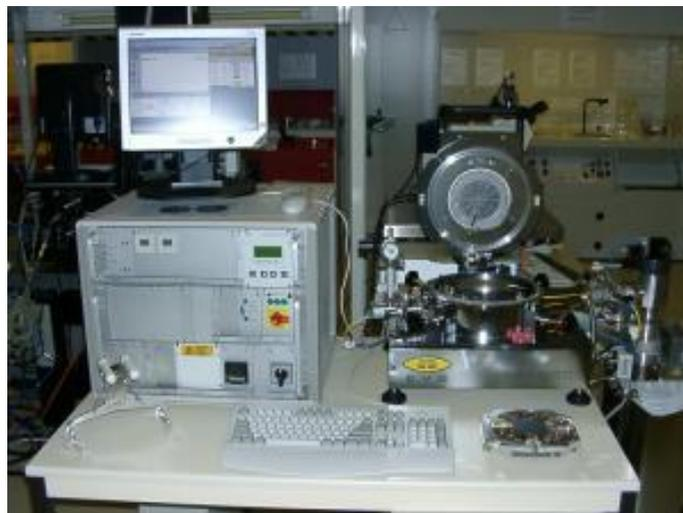
Figure 5—10 : Machine de wafer bonding.
