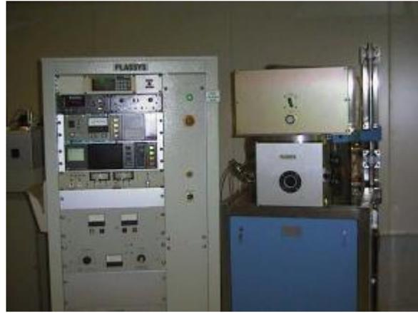
Figure 5—12 : Machine de pulvérisation cathodique Plassys.
