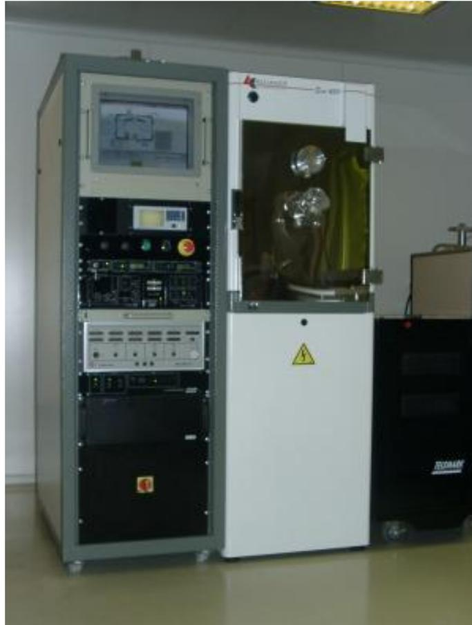
Figure 5—6 : Canon à électrons pour couche mince optique.
