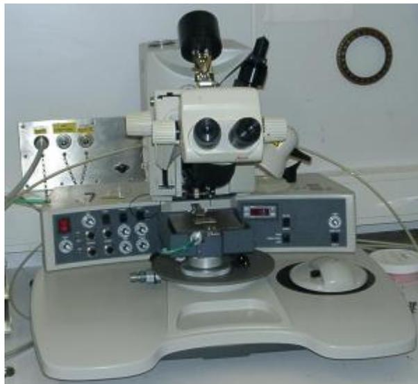
Figure 5—14 : Machine de « ball bonding ».
