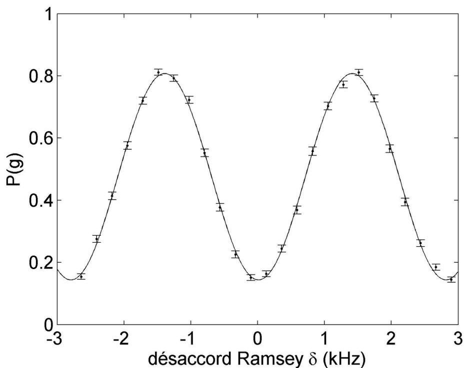
FIGURE II.16 – Franges de Ramsey obtenues par interférométrie atomique entre les zones de Ramsey  $R_1$  et  $R_2$ . Les deux impulsions sont séparées de  $360,3 \mu\text{s}$ , soit le temps de transit des atomes entre les deux zones de Ramsey. La courbe en trait plein est un ajustement sinusoïdale. Le contraste mesuré est de 75 %.
