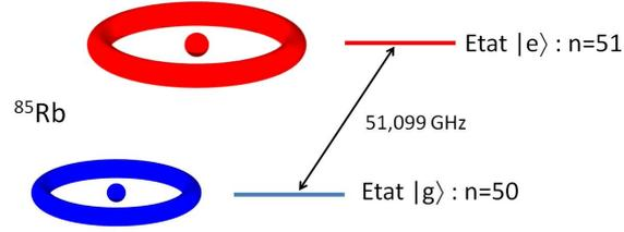
FIGURE II.2 – La transition atomique utilisée dans l’expérience relie deux niveaux circulaires successifs, et se situe dans le domaine des micro-ondes à 51,099 GHz
