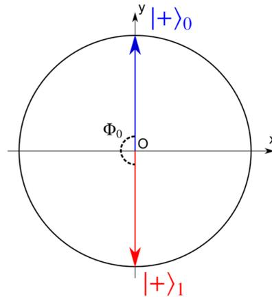
FIGURE III.6 – L'équateur de la sphère de Bloch après l'interaction dispersive avec la cavité pour une valeur de  $\Phi_0 = \pi$ . Pour les nombres de photons inférieurs à 2, la composante  $y$  du pseudo-spin atomique est parfaitement corrélée avec le nombre de photons.
