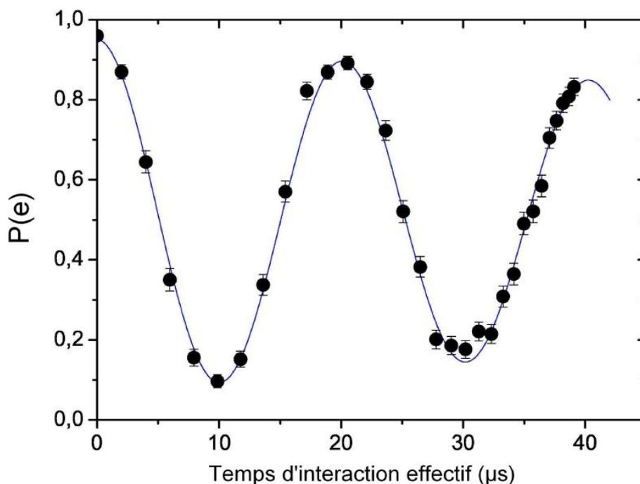
FIGURE II.5 – Oscillations de Rabi du vide. La probabilité de détecter dans  $|e\rangle$  l'atome initialement préparé dans  $|e\rangle$  varie sinusoïdalement avec le temps effectif d'interaction.
