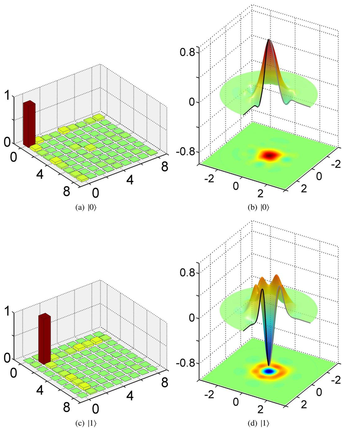
FIGURE IV.13 – Modules des éléments des matrices densités reconstruites ((a) et (c)) et fonctions de Wigner correspondantes ((b) et (d)) pour les états de Fock  $|0\rangle$  et  $|1\rangle$ .
