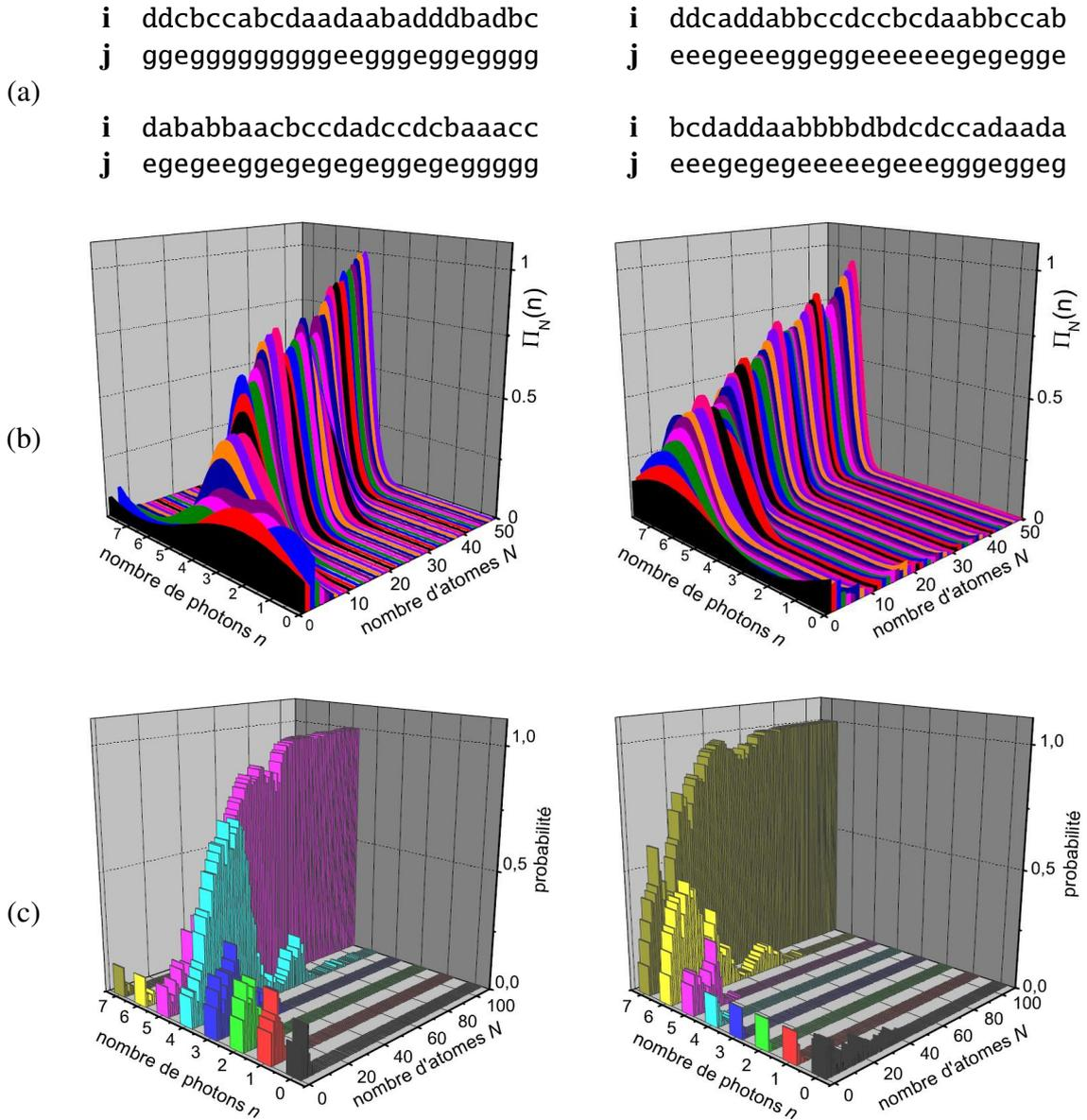
FIGURE III.11 – Réduction progressive des probabilités du champ vers un état nombre pour deux réalisations particulières de l'expérience. (a) Résultats des 50 premières détections atomiques ( $j, i$ ) où l'on note  $j$  l'état atomique et  $i$  la phase de mesure. (b) Evolution de la fonction de détermination  $\Pi_N(n)$  en fonction de  $N$  au cours des 50 premières détections atomiques. (c) Probabilités des nombres de photons en fonction du nombre  $N$  d'atomes détectés variant de 0 à 110.
