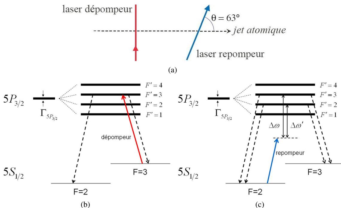
FIGURE II.9 – Schéma de principe du dispositif de sélection de vitesse : Le jet atomique rencontre d’abord un laser dépompeur qui pompe tous les atomes dans le sous-niveau  $F = 2$ , puis un Laser repompeur formant un angle de  $63^\circ$  avec ce dernier. Seuls les atomes ayant la vitesse désirée sont repompés dans le sous-niveau  $F = 3$ .
