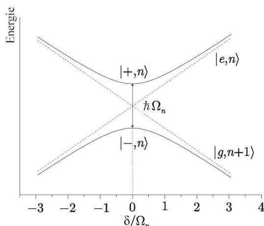
FIGURE I.14 – Énergie des états habillés en fonction du désaccord atome-champ  $\delta$ . Les lignes pointillées représentent l'énergie des états non couplés. L'interaction lève la dégénérescence des niveaux à résonance, formant un anticroisement.
