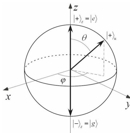
FIGURE I.11 – La sphère de Bloch permet de représenter l'état d'un système à deux niveaux
