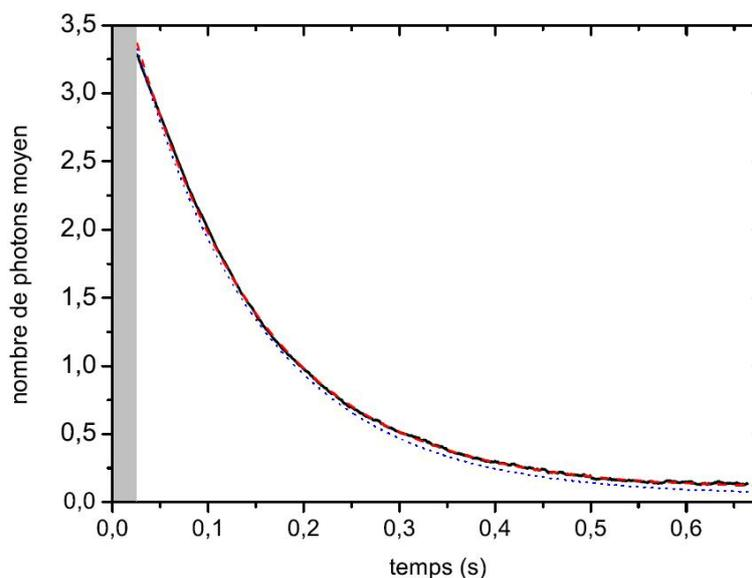
FIGURE III.14 – Moyenne sur toutes les réalisations du nombre de photons inféré  $\langle n \rangle$  au cours du temps. L'ajustement exponentiel (pointillés rouges) est indistinguable des points expérimentaux. La courbe en pointillés bleus est la prédiction purement théorique. La zone grisée correspond aux 26 premières ms nécessaires à la détection des 110 atomes réalisant la première mesure.
