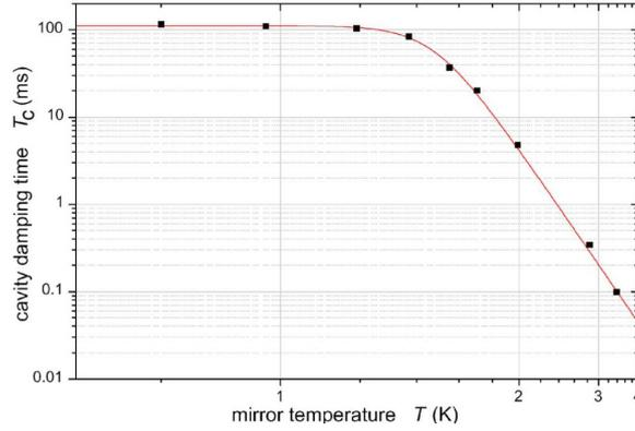
FIGURE II.4 – Temps de vie d’une cavit  supraconductrice mesur  en fonction de la temp rature du cryostat. L’ chelle horizontale est r ciproque tandis que l’ chelle verticale est logarithmique.
