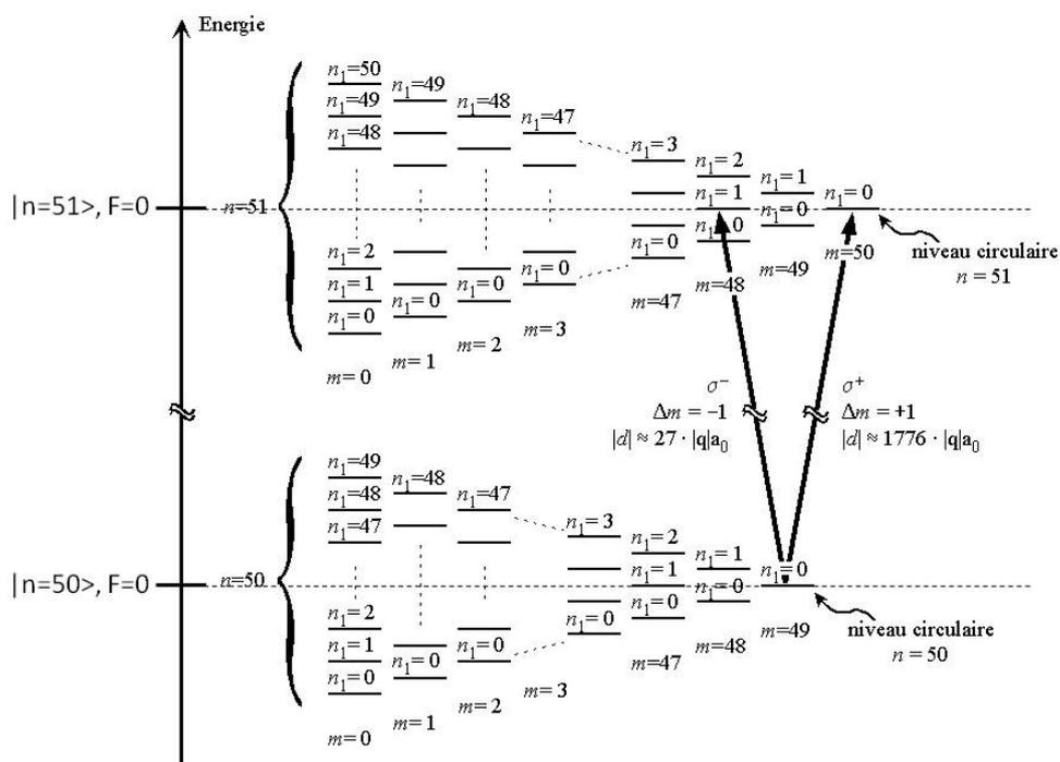
FIGURE II.3 – Diagramme d’énergie des niveaux de Rydberg  $n = 50$  et  $n = 51$  en présence d’un champ électrique. Les deux niveaux indiqués sur l’axe vertical correspondent aux énergies des multiplicités  $n = 50$  et  $n = 51$  en champ nul.
