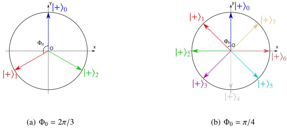
FIGURE III.8 – Représentation du pseudo-spin atomique dans le plan équatorial de la sphère de Bloch après interaction dispersive avec un champ contenant  $n$  photons. (a) Pour une valeur de  $\Phi_0 = 2\pi/3$ . (b) Pour une valeur de  $\Phi_0 = \pi/4$ .
