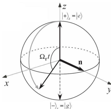
FIGURE I.12 – Effet d’une impulsion de micro-onde classique sur le vecteur de Bloch d’un atome initialement préparé dans l’état  $|e\rangle$ . Le vecteur unitaire  $\mathbf{n}$  autour duquel s’effectue la rotation se trouve dans le plan équatorial. La phase de l’impulsion micro-onde détermine son angle azimutal. Ici, on a choisi  $\phi = \pi/2$ .
