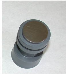
Figure A4-2 : Projectile du lanceur Pyrène constitué d'un sabot en delrin et de l'impacteur.
