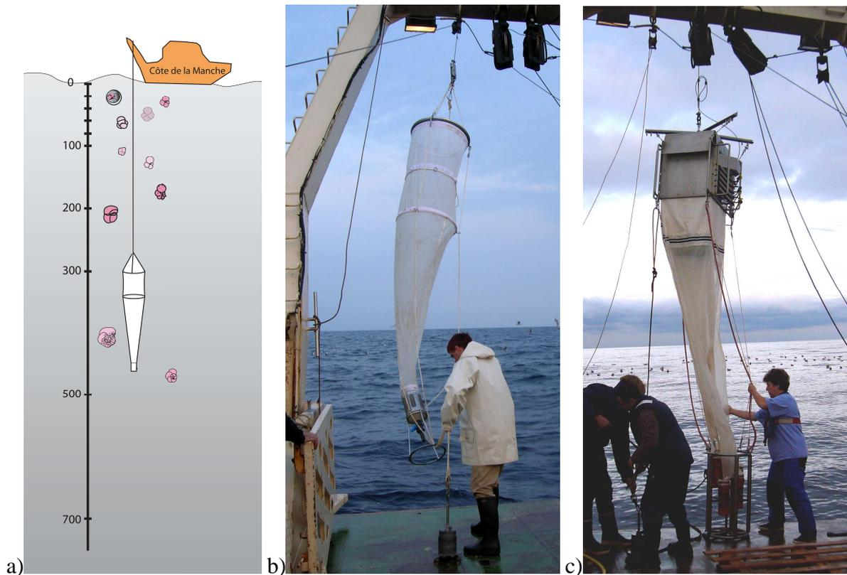
Figure I-13: a) Schéma montrant les différents intervalles de prélèvement des filets à plancton ouvrant-fermant en pêche verticale ; b) Filet à plancton WP2 (Neven Lončarić) ; c) Multinet Hydrobios® (Hélène Howa).
