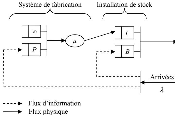
Figure 1.15. Représentation du système par les files d'attente
