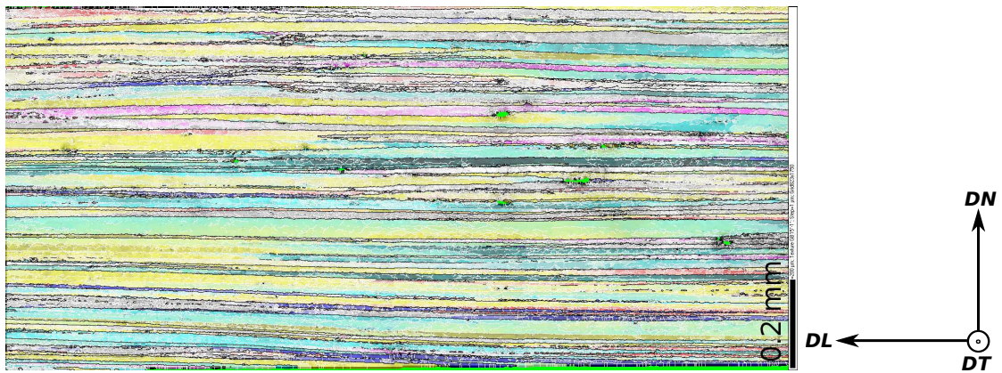
FIG. II.7: Cartographie EBSD dans le plan DN-DL de l'alliage 7050 après déformation dans le channel die : \varepsilon = 2.6 , \dot{\varepsilon} = 0.1s^{-1} et T = 420^{\circ}C .
