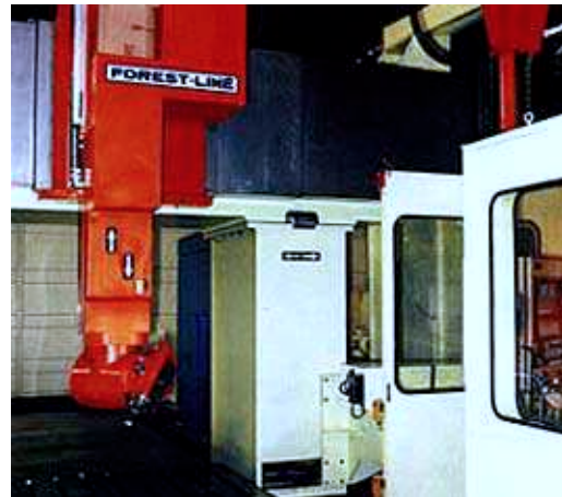
Figure IV-2 : Machine 5 axes type portique à structure cartésienne.
