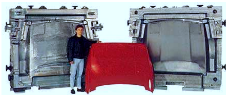
Figure I-3 : Matrice d'emboutissage avec surface gauche.
