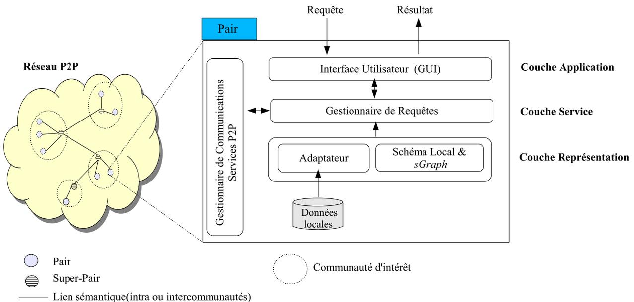
Figure 3.3 – Architecture d'un pair.
