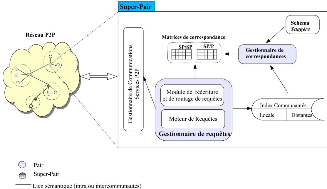
Figure 3.4 – Architecture d'un super-pair.
