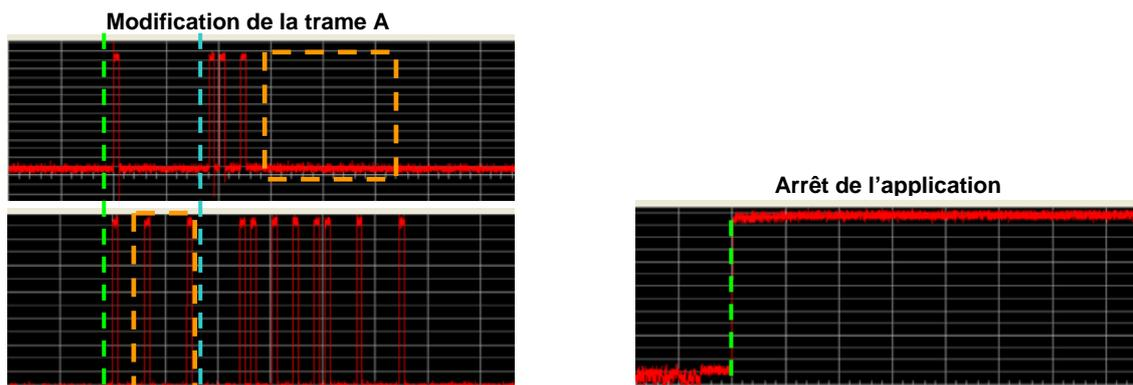
Figure III-85- Captures de trames en sortie ARINC : exemples de SEFI
