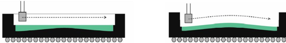
Figure II-38 - Contraintes liées à l'amincissement d'un composant en face arrière : planéité et homogénéité d'épaisseur
