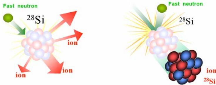
Figure I-11 - Illustration d'une interaction neutron-silicium et des ions de recul produits
