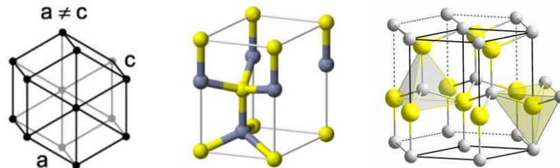
FIG.3-4: Structure cristalline hexagonale, cellule unitaire d'une structure Wurtzite et structure Wurtzite complète
