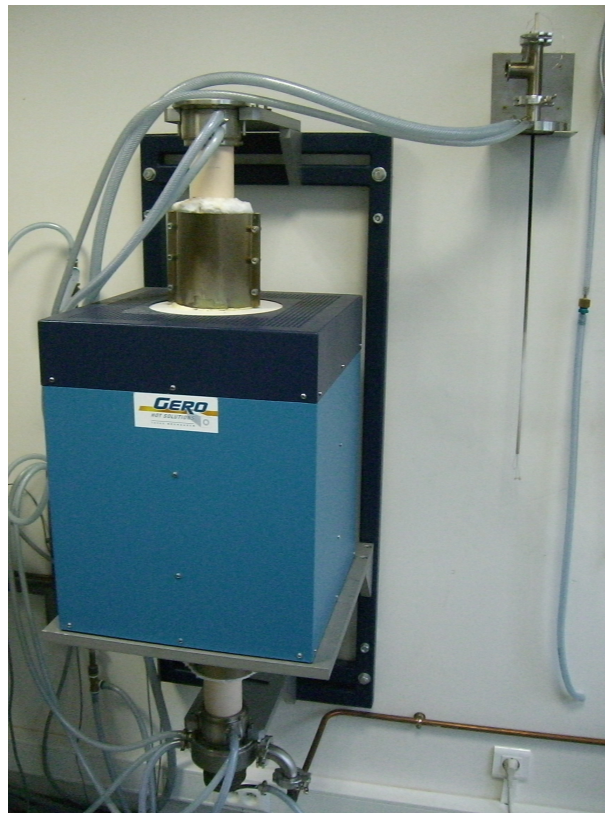
FIG. 1.1 – Four vertical du laboratoire Géomatériaux ayant servi à la synthèse des verres de composition complexe
