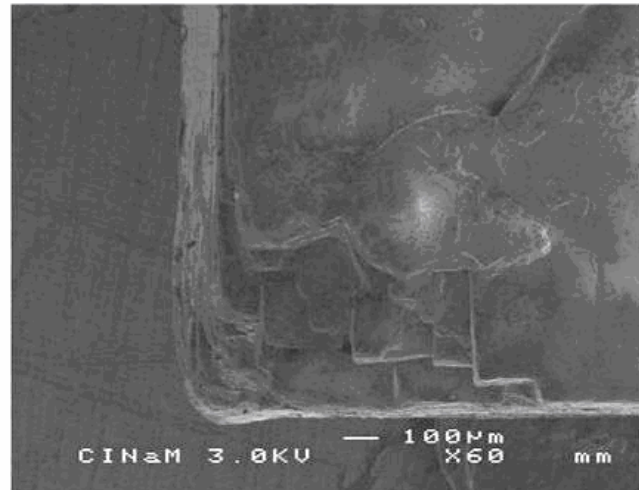
Figure XIV-13: Vue en microscopie électronique à balayage du profil de la face basale après expérience.
