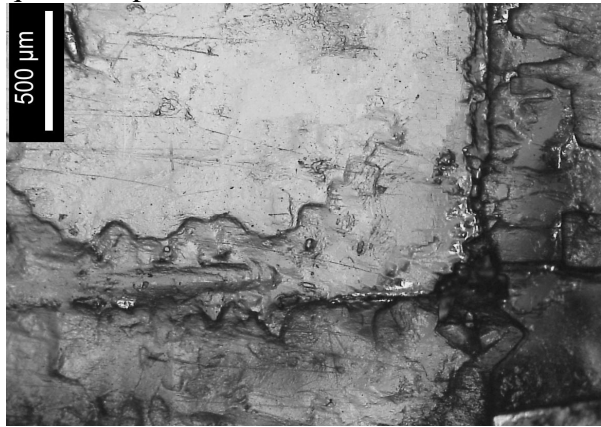
Figure V- 10: Vue en microscopie photonique en lumière réfléchi d'un angle de la face basale du cristal C10mm après 300h d'expérimentation (T=20°C HR=80%).
