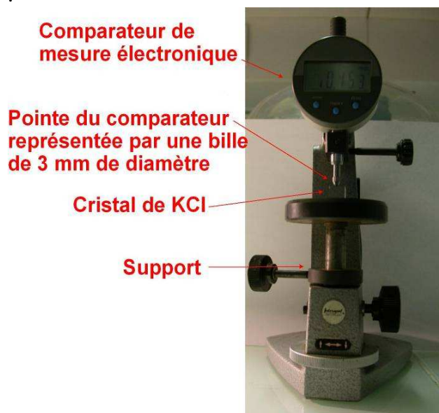
Figure II- 13: Comparateur de mesure avec son support
