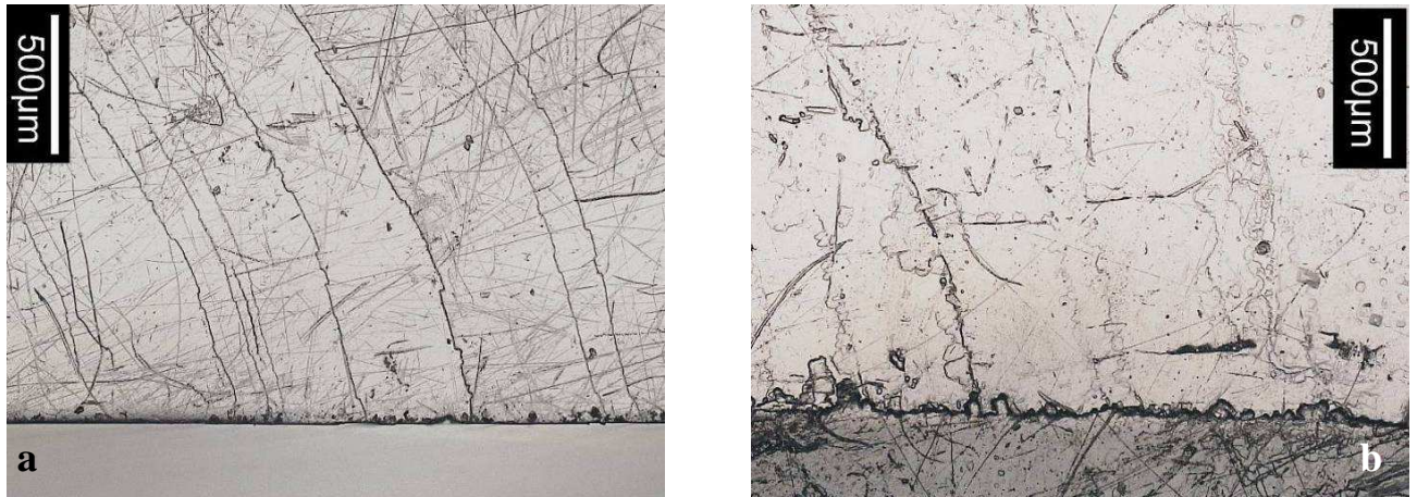
Figure III- 33 : Vue en microscopie photonique d'un bord de la face basale du cristal CPC3.80% avant expérience (à gauche) et après expérience (à droite).
