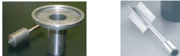
FIGURE 4.1 : a- Géométrie de cylindres coaxiaux, b- Géométrie du Vane test.
