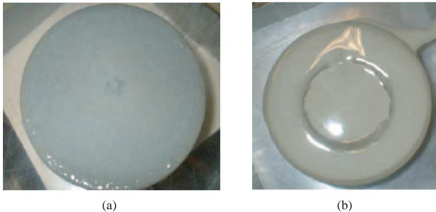
**FIGURE 4.25 :** Faciès des pâtes de ciment à la fin de l'essai de compression simple : a- pâte restée homogène après écrasement à grandes vitesses (100 mm/min), b- séparation de phase dans la pâte après écrasement à faibles vitesses (0,1 mm/min).
