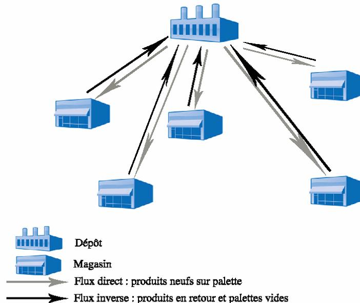
Les caractéristiques des tournées dans ce réseau sont résumées dans la figure 1.3. Les véhicules partent du dépôt chargés du stock de produits qu'ils doivent distribuer dans leur tournée. Le véhicule doit arriver dans la fenêtre de visite pour chaque site visité. Chacun des sites est soit livré en produits soit collecté en produits en retour et en palettes vides soit les deux en même temps. Ce qui amène le véhicule à retourner au dépôt également chargé des diverses collectes.
