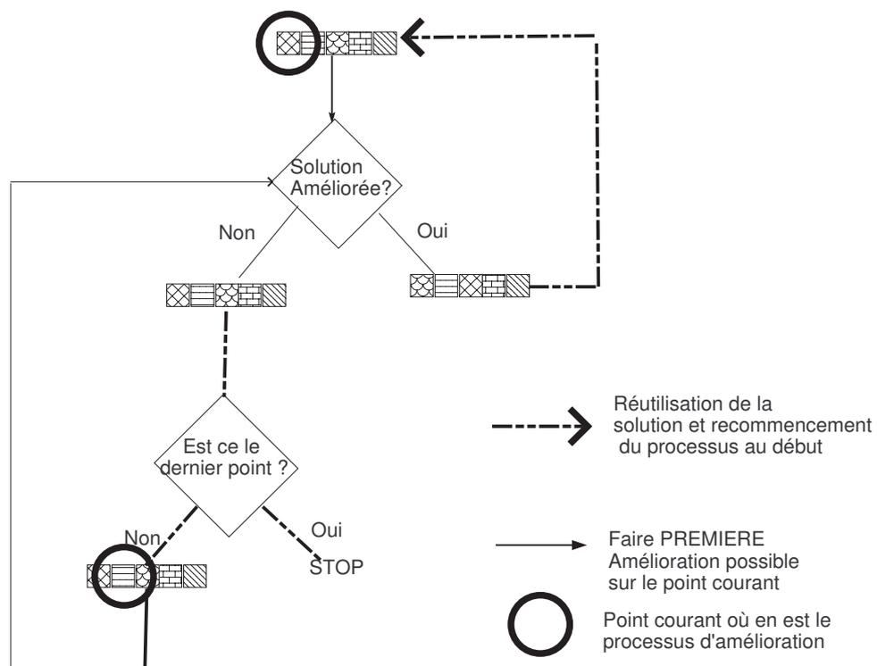
**Algorithm 3** Recherche Locale utilisée par  $\overrightarrow{E_i E_o D_o D_i O}$
