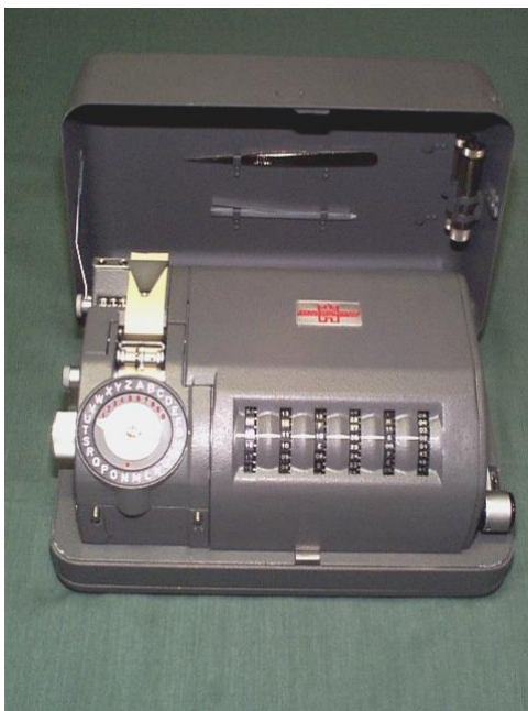
FIG. 3.1 – Machine à rotors de type « Hagelin » (source : http://home.ca.inter.net/hagelin/crypto.html ).
