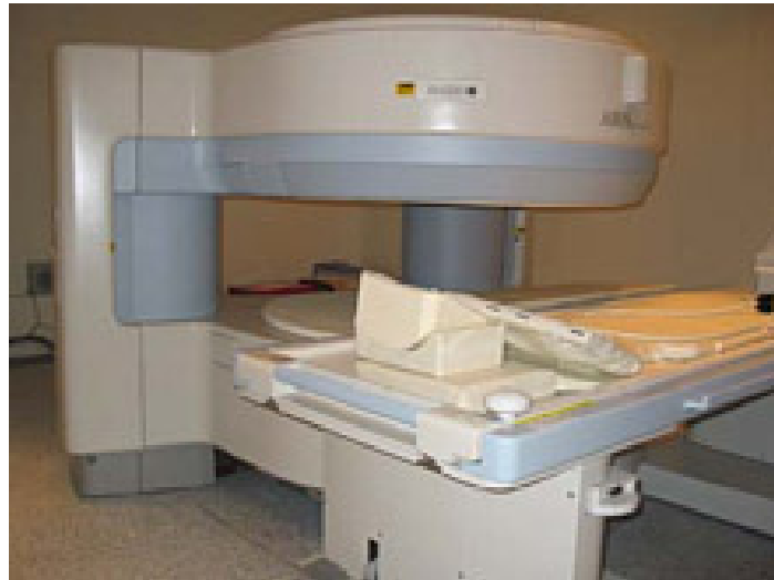
Figure 14. Machine d'IRM à aimant permanent (0.2 Tesla)
