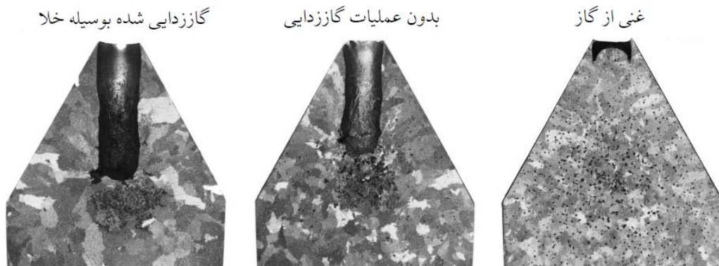
شکل ۱۹.۲: تاثیر گازهای حل شده و عملیات گاز زدایی بر نحوه توزیع عیوب انقباضی گازی در آلیاژ Al-10Si [۶۴].
