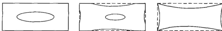
شکل ۲۳.۲: شماتیک نحوه تشکیل عیوب انقباضی متمرکز در قطعات ریخته گری، حفره انقباضی داخلی (چپ)، کشیدگی کم عمق سطحی و حالت مخلوط (وسط) [۷].
