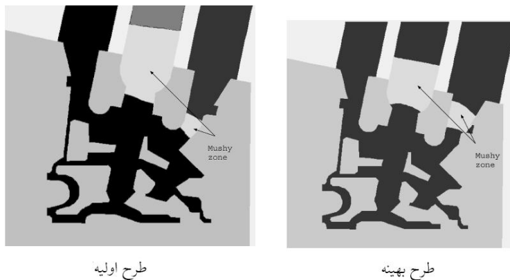
شکل ۴.۴: بهینه سازی پارامترهای شکل تغذیه برای یک بلوک سیلندر آلومینیومی [۸۸].
