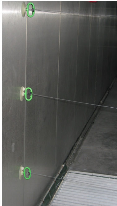
FIGURE 5.6 – Dispositif de mesure des émissions vers l'air en soufflerie.
