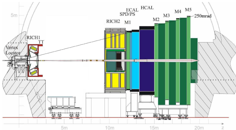
FIG. 3.14: Disposition des éléments du système d'identification des particules dans le détecteur LHCb
