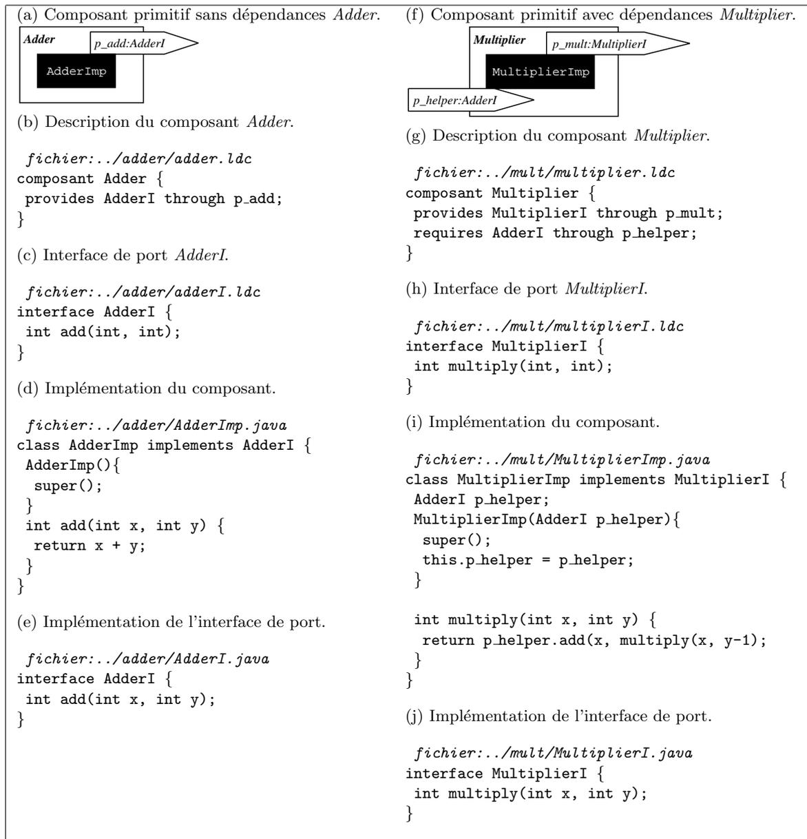
FIG. 7.1 – *MoSCo* : Définition des composants *Adder* et *Multiplier*.
