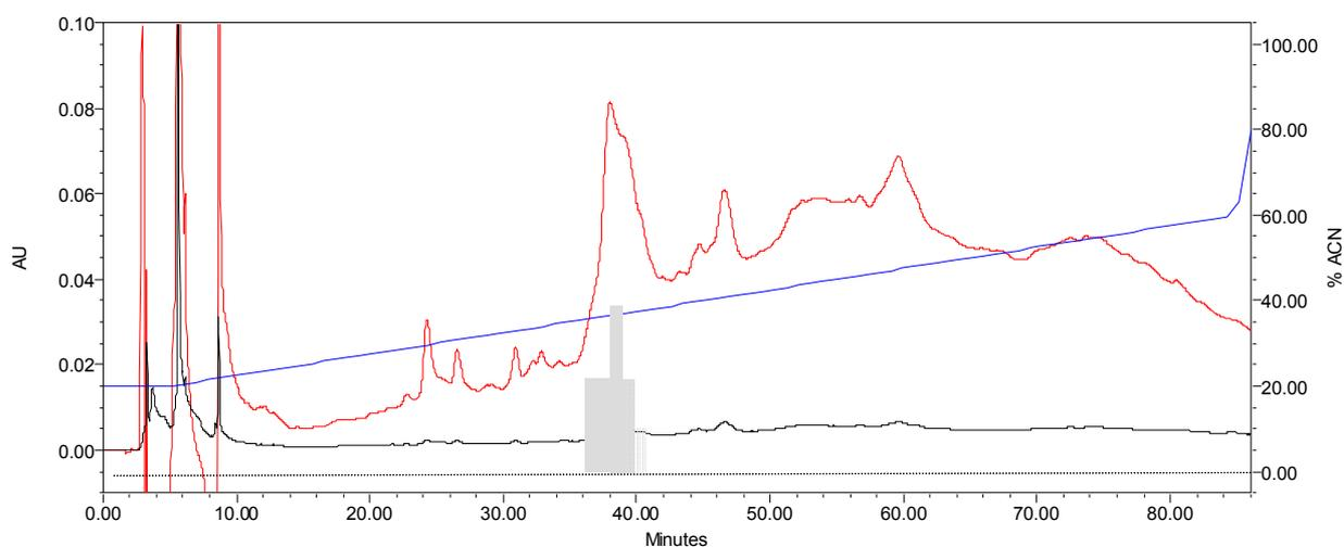
**Figure 35 :** Analyse par RP-HPLC (colonne C18, Interchim, UP5HSC-25QS 4,6 mm x 250 mm) des fractions 14,5-15-15,5 actives rassemblées provenant de la purification par chromatographie échangeuse de cations. La zone grisée correspond aux fractions dans lesquelles l'activité a été retrouvée.
