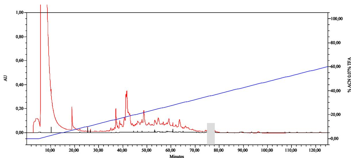
**Figure 31 :** Analyse par RP-HPLC (colonne C18, Interchim, UP5HSC-25QS 250 x 4,6 mm), des fractions 23 à 26 rassemblées, provenant de l'élution sur colonne de gel filtration TSK gel G2000 SWXL, par un gradient d'ACN-0,07% TFA à  $0,5\%.\text{min}^{-1}$  pour un débit de  $0,8 \text{ mL}\cdot\text{min}^{-1}$ .
