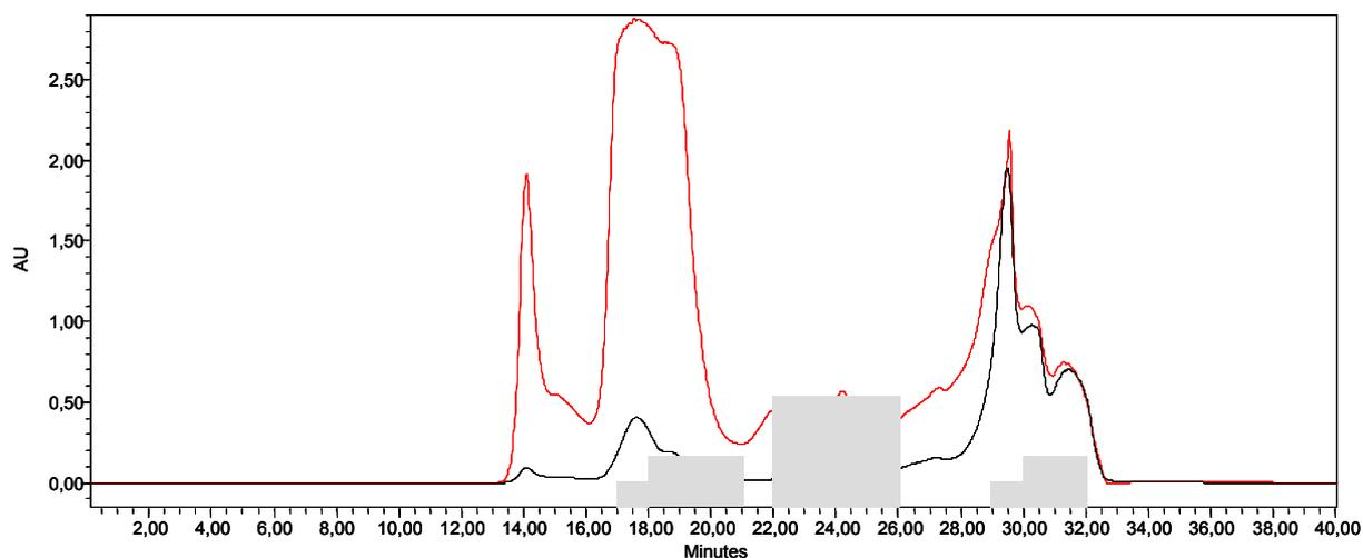
**Figure 30 :** Chromatogramme de la fraction-SPE 40% après élution par 45% ACN-0,1% TFA, débit à  $0,5 \text{ mL}\cdot\text{min}^{-1}$  sur une colonne de gel filtration (TSK gel G2000 SWXL, 7,8 mm x 30 cm ; TSK gel SWXL Guardcolumn, 7,5 mm x 7,5 cm).
