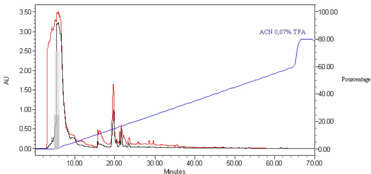
**Figure 29** : Purification par RP-HPLC C18 (C18 UP5HSC-25Q5 250 x 4,6 mm) des fractions 52 à 56 rassemblées après chromatographie d'exclusion stérique. Les pourcentages d'activité antivirale et de cytotoxicité sont représentés respectivement en gris clair et foncé sur le chromatogramme.
