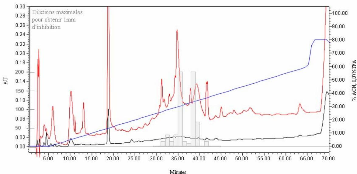
**Figure 51 :** Chromatogramme du précipité de *Pseudoalteromonas* spp. souche hCg 5, obtenu par injection de 590 µg de protéines totales sur une colonne RP-HPLC C18 (C18 UP 5HSC-25QS, 250 x 10 mm) munie d'une colonne de garde (Upti-screen Modulo Cart, 10 mm i.d 5HS49750). Le gradient d'ACN est représenté en bleu, le débit est de 5 mL.min<sup>-1</sup> d'ACN-0,07% TFA 1%.min<sup>-1</sup>. Les fractions actives sont représentées en gris.
