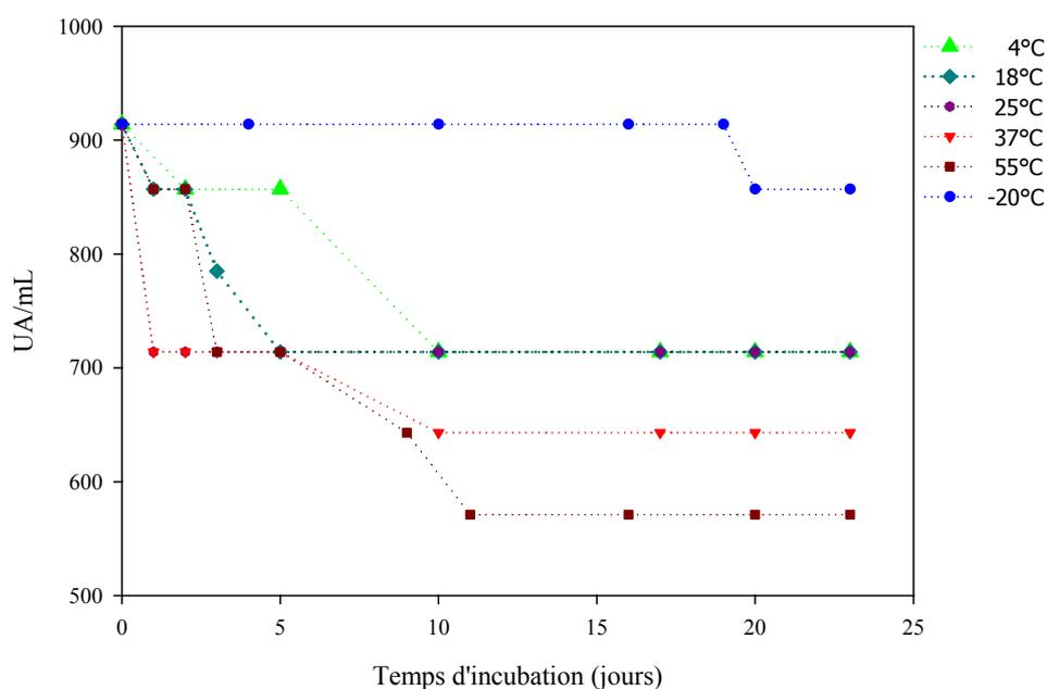
**Figure 47 :** Activité inhibitrice (UA/mL) du précipité de *Pseudoalteromonas* spp. souche hCg 5, après différents temps d'incubation à différentes températures. La souche cible utilisée est *Y. ruckeri*.
