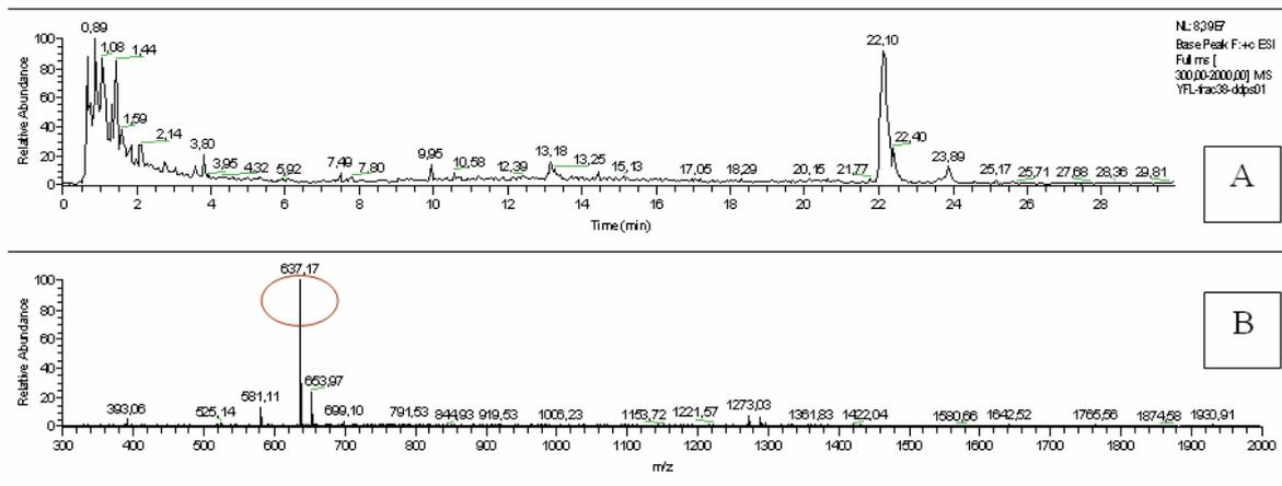
**Figure 36 :** (A) Chromatogramme ionique total de la fraction 38, issue de la séparation sur RP-HPLC des fractions actives après chromatographie échangeuse de cations - (B) Spectre de masse du pic chromatographique majoritaire de temps de rétention 22,10 min.
