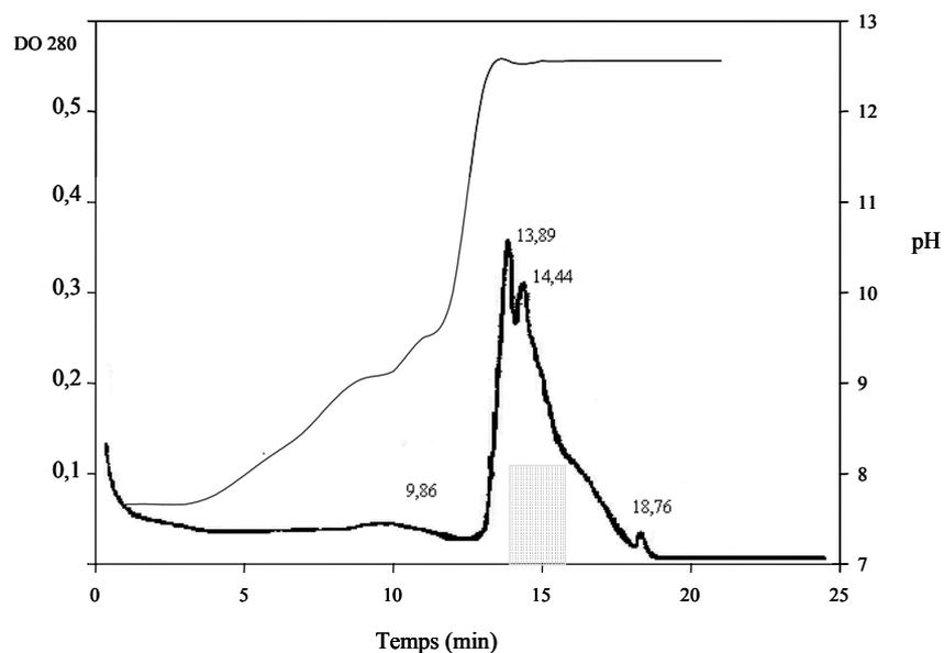
**Figure 34 :** Chromatogramme de la fraction-SPE 40% après élution par un gradient de pH sur colonne échangeuse de cations (CIM Disk monolithic column, 16 i.d. x 6 l. mm. Interchim). La zone grisée correspond aux fractions dans lesquelles l'activité a été retrouvée.
