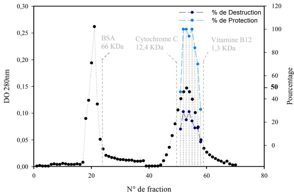
**Figure 28** : Purification par chromatographie d'exclusion stérique (Sephadex<sup>®</sup> G50, h : 100cm, Ø : 2,5cm) de la fraction-SPE 0%. L'éluion est assurée par de l'acide acétique 1%, à un débit de 0,2 mL.min<sup>-1</sup> et 8 mL sont collectés par fraction. La densité optique à 280 nm (losange noir) et l'activité antivirale ont été déterminées dans chaque fraction.
