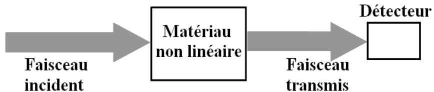
Figure 4: Schéma descriptif la méthode de transmission à un faisceau
