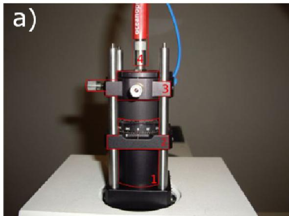
**Figure III-12: Détail du montage optique en sortie du microscope : (1) tube qui contient la lentille de collection ; (2) polariseur ; (3) translateur XY pour positionner correctement la fibre optique (4).**
