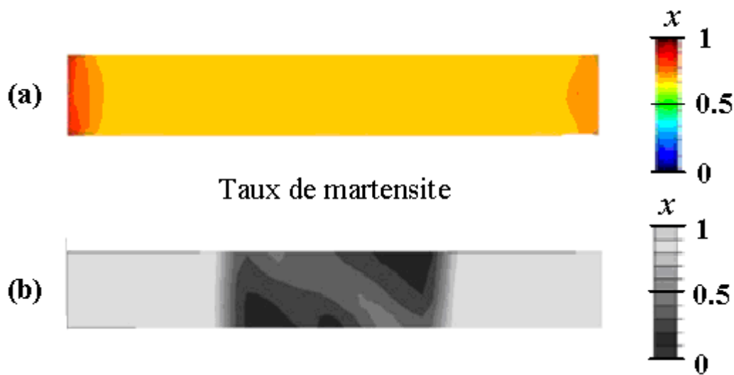
Fig.3.3.18 – Distribution de martensite obtenue (a) par [Liu 07] avec h_l = 160 \text{ W.m}^{-2}.\text{K}^{-1} (b) par [Anand 03] avec h_l = 12 \text{ W.m}^{-2}.\text{K}^{-1}
