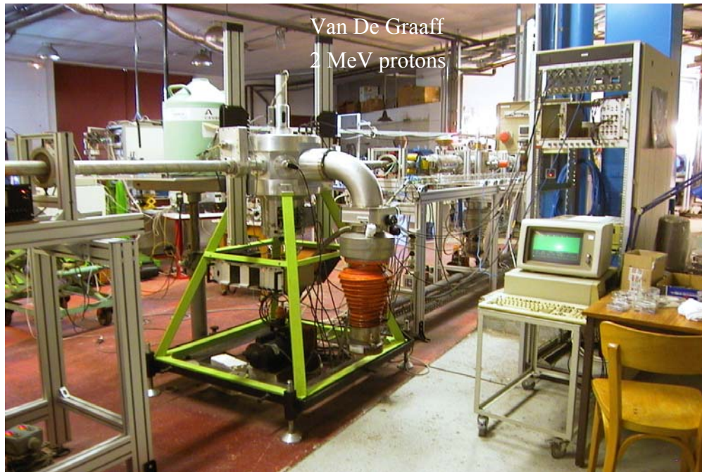
Figure II- 17 : Salle d'expérience de l'accélérateur Van de Graaff 4 MV de l'InESS.
