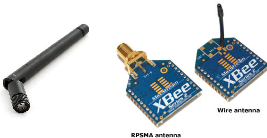
FIGURE 4.11 – Module de communication sans fils Zigbee développé par la société digi.
