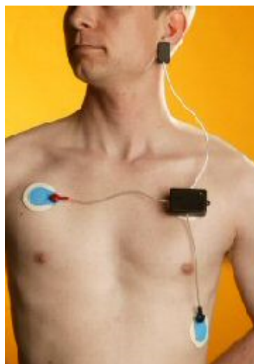
FIGURE 3.3 – Dispositif ambulatorie pour la mesure de l'électrocardiogramme, développé par l'Institut Fraunhofer. Le dispositif réalise l'acquisition et l'envoi de l'électrocardiogramme et du signal photoplethysmographique.
